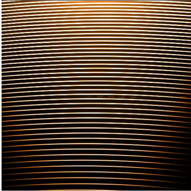
Rysunek 4: Widmo echelle lampy tungstenowej. Długość fali maleje od lewego górnego rogu ramki ( \lambda \approx 8400 \text{ \AA} ) do prawego dolnego ( \lambda \approx 5000 \text{ \AA} ).
