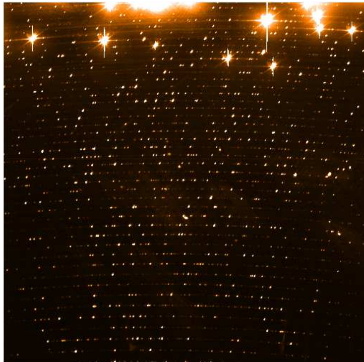
Rysunek 5: Widmo lampy kalibracyjnej, torowo-argonowej. Widoczne pojedyncze linie emisyjne.
